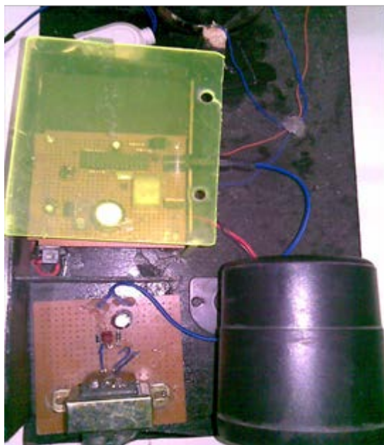
Gbr 13. Rangkaian Mikrokontroler AT 8 Yang Terhubung Dengan Alarm
