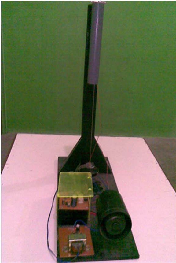
Gbr 12. Pendeteksi Gempa Menggunakan Mikrokontroler AT 8
