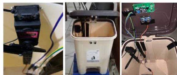
Gbr. 14. Lokasi instrumen MCU pada bak sampah
